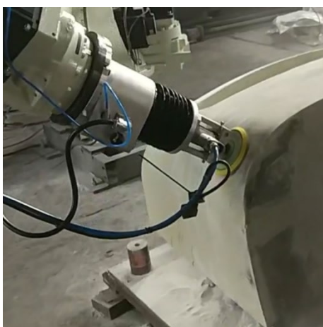
铸铁表面腻子打磨
